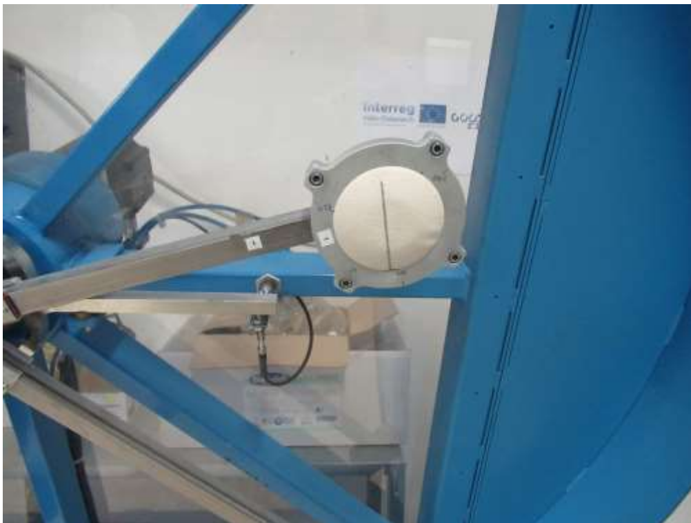
Figura 104 Attrezzatura per la determinazione coefficient d'attrito in laboratorio – Particolare portacampione
