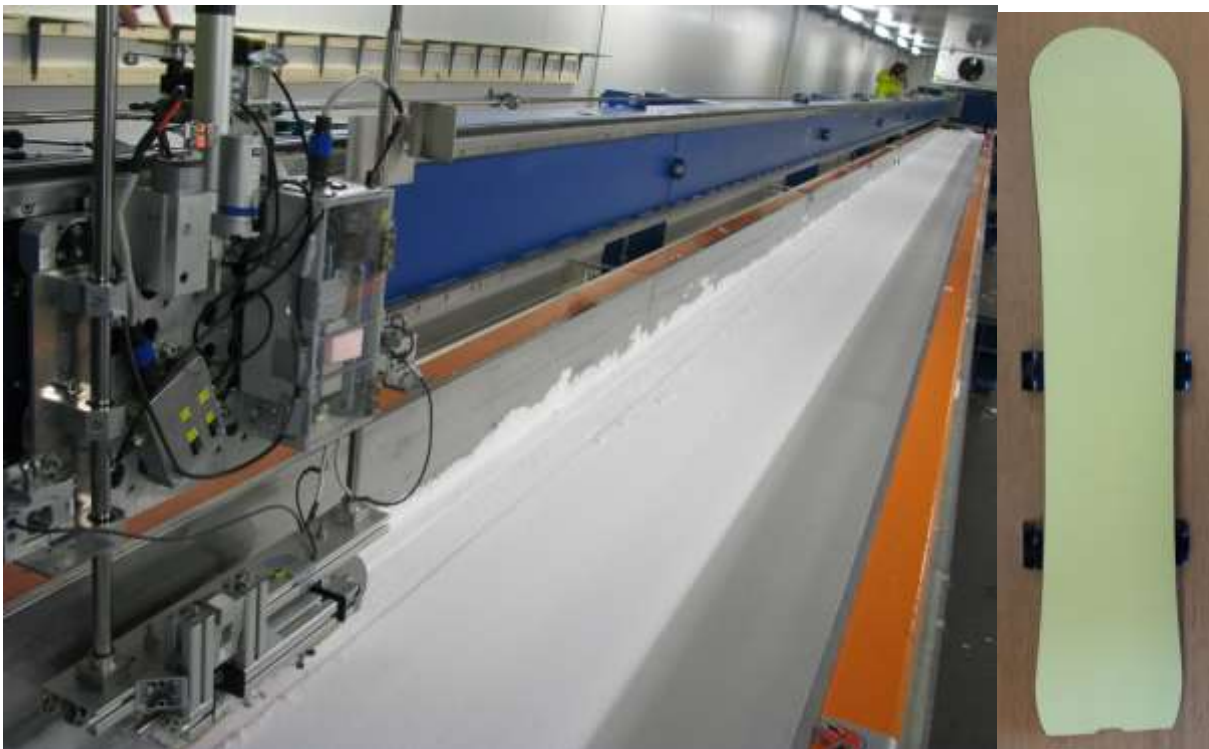
Figura 100: Il tribometro lineare (a sinistra) e lo sci su cui sono stati incollati i tessuti (a destra).
