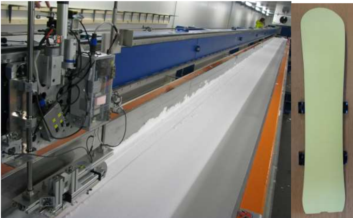
Abbildung 100: Das lineare Tribometer (links) und der Ski, auf den die Stoffe geklebt wurden (rechts).
