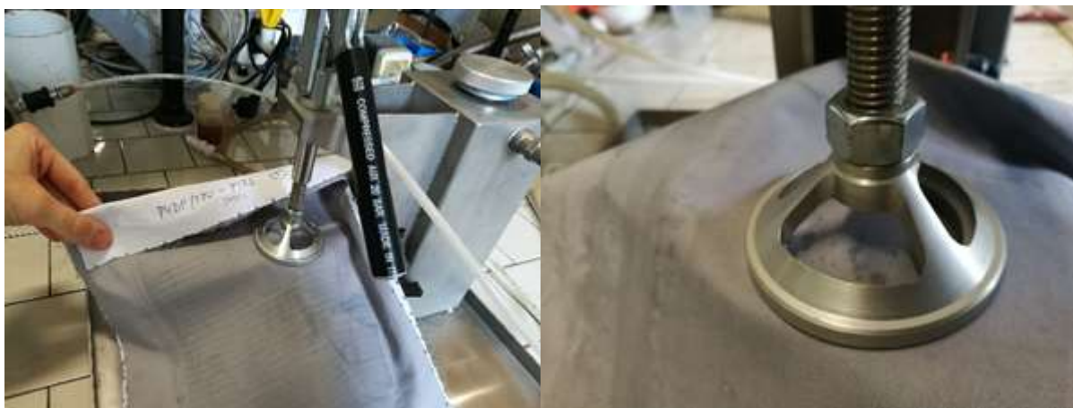
Figura 136. Test di colonna d'acqua sui campioni accoppiati
