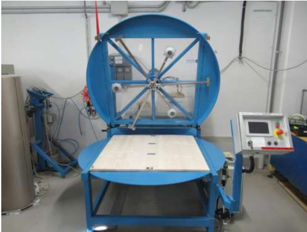
Figura 103 Attrezzatura per la determinazione coefficient d'attrito in laboratorio
