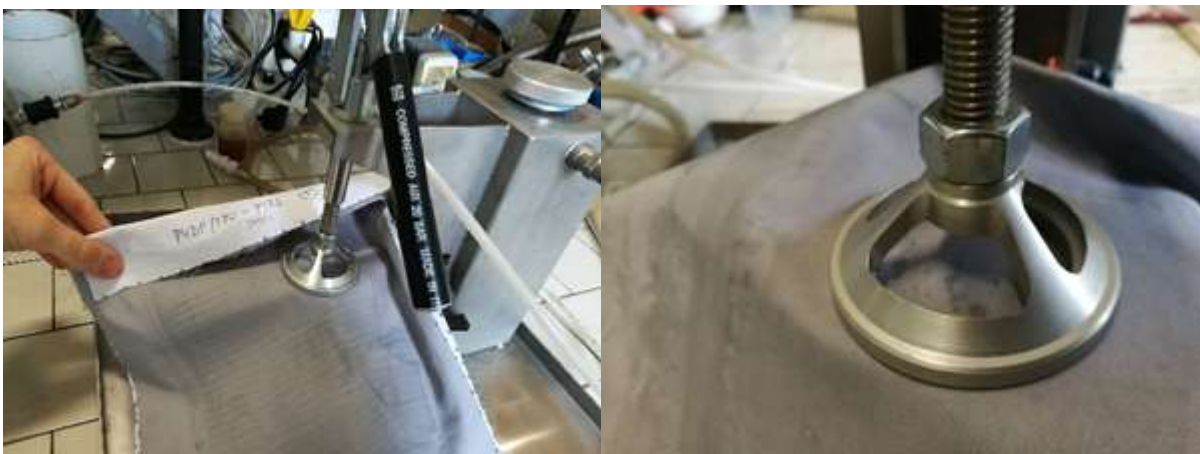
Abbildung 136. Wassersäulentest an gepaarten Proben
